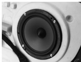
Procéder au rerivetage du haut-parleur FOCAL (rivet aluminium 4x16mm).
