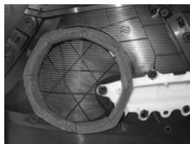
Laisser le joint mousse monté d'origine sur la garniture.
