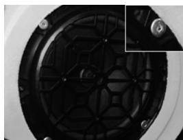
Opération de dérivetage à l'aide d'un forêt métal Ø 5,5 / 6 mm.
