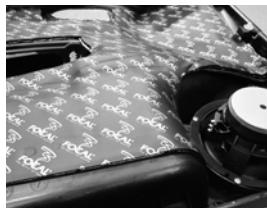
Une isolation acoustique est nécessaire afin de supprimer les vibrations dûnt à la fixation du haut-parleur sur la garniture (ref. B.A.M).
