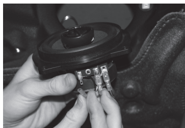
5. Connexion du connecteur sur le bornier du haut-parleur du Kit IFBMW-C.
