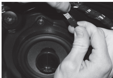
7. Connexion du câble d'origine sur le Kit IFBMW-C.
