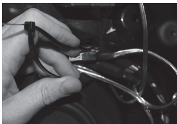
8. Fixation du connecteur sur le faisceau d'origine.
